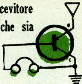
Riprendiamo da «Halta Frequencia» il circuito di un ...«ricevitore» dalla semplicità imbattibile.
